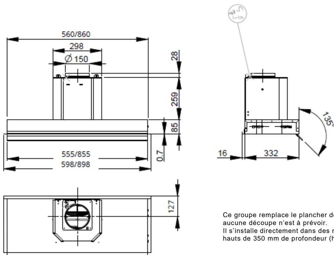
Ce groupe remplace le plancher de meuble, aucune découpe n'est à prévoir. Il s'installe directement dans des meubles hauts de 350 mm de profondeur (hors porte).
