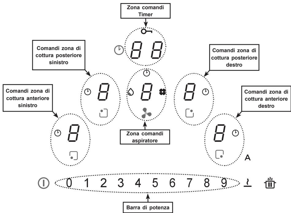
Le zone comandi delle zone di cottura, dell' aspiratore e il timer possono essere attivate premendo sul Digit di riferimento **B**.
