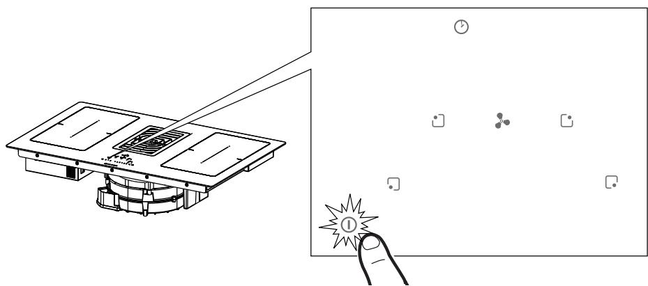
Druk 2 seconden op de On/Off-toets ① om de functies van de kookplaat in te schakelen en te activeren. Alle digits tonen 8. En die van de timer ' C L '.
