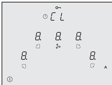
In questo momento il piano è acceso ma tutte le zone di cottura e la cappa sono a potenza zero. Il Piano si spegne automaticamente dopo 20 secondi di inutilizzo.
