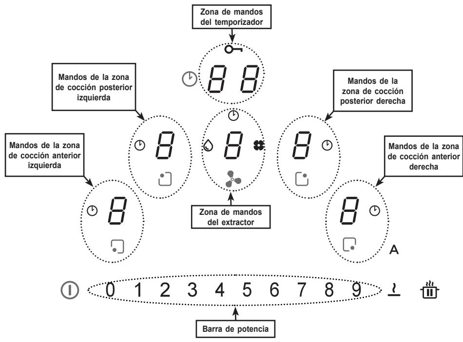
Los mandos de las zonas de cocción, del extractor y del temporizador se pueden activar pulsando el dígito de referencia **B**.
