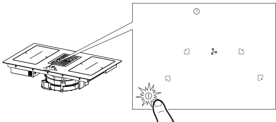
Premere per 2 secondi il tasto On/Off ① per accendere e attivare le funzioni del piano. Tutti i Digit mostrano  $B.$  e quelli del Timer “ C L ”.
