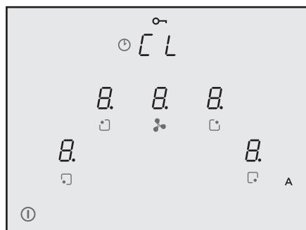
Entonces, la placa está encendida, pero no hay potencia ni en las zonas de cocción ni en la campana. La placa se apaga automáticamente si transcurren 20 segundos sin usarla.
