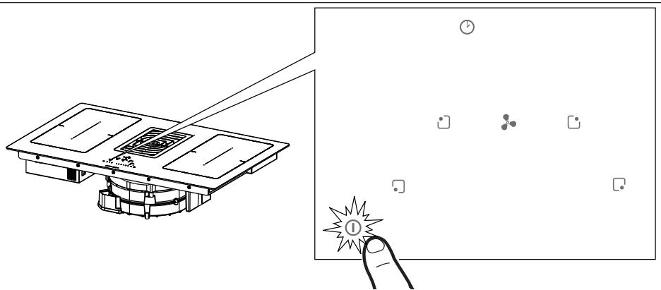
Pulse durante dos segundos la tecla de encendido/apagado ① para encender y activar las funciones de la placa. Todos los dígitos muestran 8, salvo los del temporizador en los que se visualiza "C L".
