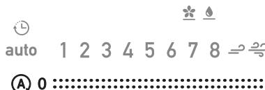
Sterowanie strefami grzewczymi, wyciągami oraz timerem można aktywować naciskając odnośny przycisk cyfrowy.
