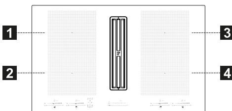
**1,2 Strefa grzewcza elastyczna 1 + 2 w połączeniu**
