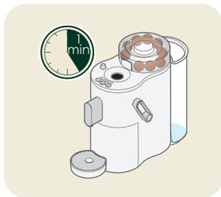
Si la machine à café n'est pas utilisée pendant 1 minute ou si l'on appuie sur la touche de nettoyage
