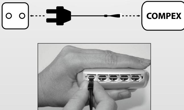
Desenchufe todos los cables del estimulador antes de recargarlo. Conecte el cargador a una toma de corriente y conecte el estimulador deslizando la tapa roja hacia la derecha para acceder al conector del cargador. Se recomienda encarecidamente cargar completamente la batería antes de su primer uso para mejorar su rendimiento y vida útil.
