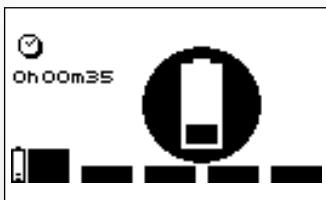
A duração do carregamento é apresentada no ecrã. Assim que o carregamento estiver concluído, o ícone de bateria pisca. Deslique o carregador: o estimulador desliga-se automaticamente.
