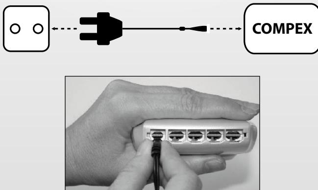
Retirer tous les câbles de stimulation du stimulateur avant de le recharger. Brancher le chargeur sur une prise murale et connecter le stimulateur en faisant glisser le couvercle rouge vers la droite pour libérer le connecteur du chargeur. Il est fortement recommandé de charger intégralement la batterie avant la première utilisation afin d'améliorer ses performances et sa durée de vie.
