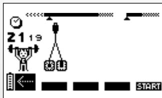
Il dispositivo emette un tono e visualizza alternativamente il simbolo di una coppia di elettrodi e una freccia che punta sul canale in cui è stato rilevato un problema. Nell'esempio sopra riportato, lo stimolatore ha rilevato un errore sul canale 1.
