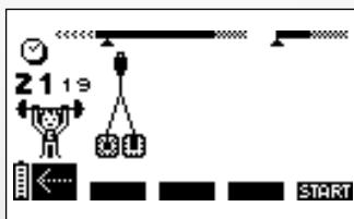
El dispositivo emite un sonido y muestra alternativamente el símbolo del par de electrodos y una flecha que apunta hacia el canal en el que se ha detectado el problema. En el ejemplo anterior, el estimulador ha detectado un error en el canal 1.
