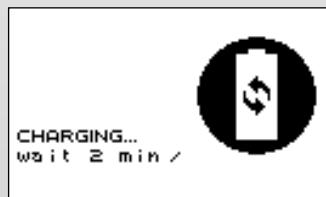
Als die gereed is en de batterij naar behoren werkt, wordt het laden gestart; in dit geval wordt ten eerste aanbevolen de batterij op te laden en weer te ontladen door op de knop van kanaal 4 te drukken en deze cyclus, die maximaal 12 uur kan duren, te starten. Als er echter een defect wordt gevonden, verschijnt het volgende scherm en moet de batterij worden vervangen.
