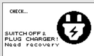
Als het ladingsniveau van de batterij erg laag is, begint een herstelcyclus die twee minuten duurt.
