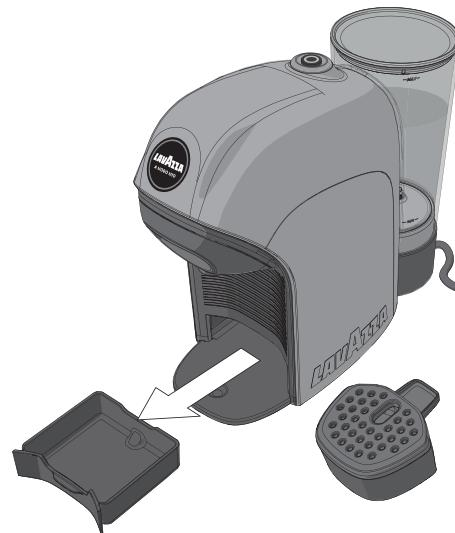
**i** Regelmäßig prüfen, ob der Behälter für verbrauchte Kapseln und der Tropfenfängerbehälter voll sind, um Betriebsstörungen und Schäden an der Maschine zu vermeiden.
