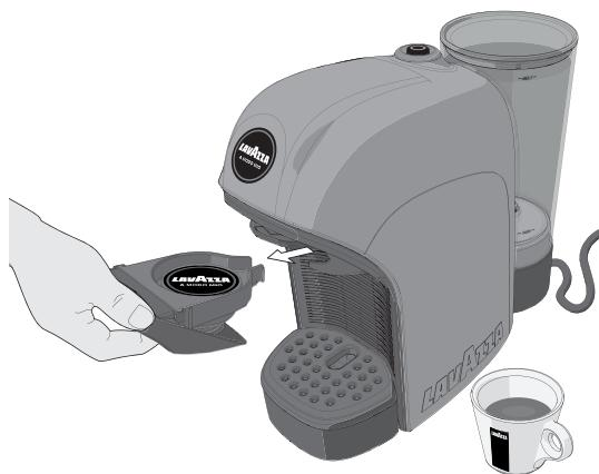
**8** Colocar el cajón de las cápsulas en la máquina.
