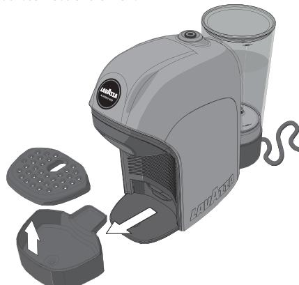
**i** Nach Abgabe von 10 Kaffee bzw. alle zwei/drei Tage den Wasserüberschussbehälter und die Tropfenauffangschele entleeren und reinigen.
