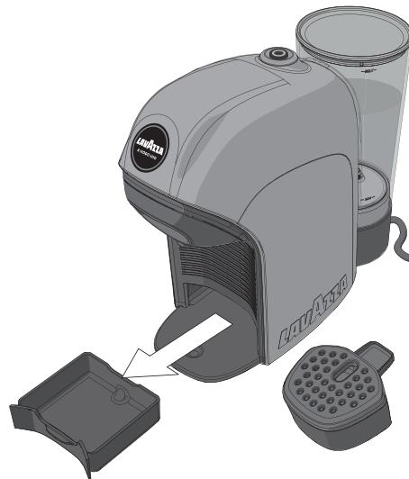
**i** Vérifier périodiquement que le tiroir à capsules usagées et le tiroir ramasse-gouttes ne sont pas pleins pour éviter des mauvais fonctionnements et des dommages à la machine.
