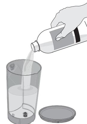
**3** Remettre en place le réservoir d'eau après y avoir versé une solution décalcifiante.
