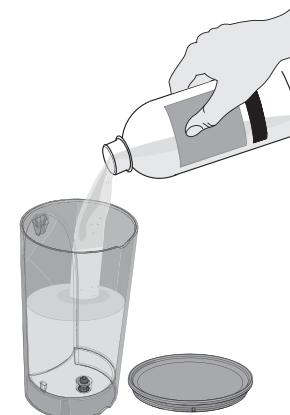
**3** Colocar el depósito de agua con la solución descalcificante en la máquina.
