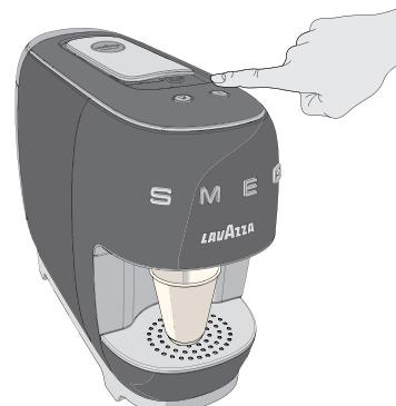
**10** La descalcificación consiste en dosificar 60 ml de solución con una pausa de 15 segundos hasta que el depósito se vacíe.
