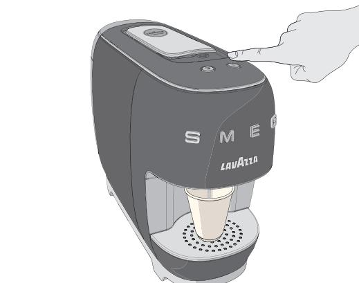
**10** Le détartrage consiste en un débit de 60 ml de solution suivi d'une pause de 15 secondes et cela jusqu'à ce que le réservoir soit vide.
