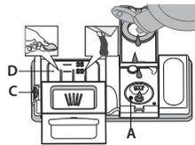
Le liquide de rinçage permet à la vaisselle de SÉCHER plus facilement. Le distributeur de liquide de rinçage **A** devrait être rempli lorsque le **voyant de NIVEAU DE LIQUIDE DE RINÇAGE** est allumé à l'écran.
