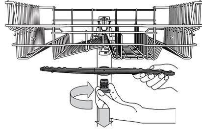
Pour enlever le gicleur supérieur, tournez l'anneau de verrouillage en plastique dans le sens horaire. Le bras d'aspersion supérieur doit être remplacé de façon que le côté avec le plus grand nombre de trous est placé vers le haut.
