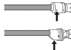
Pour les tuyaux équipés d'une protection contre les fuites : vérifiez la fenêtre d'inspection de la soupape de sécurité (voir la flèche). Si elle est rouge, la fonction de protection contre les fuites s'est déclenchée et le tuyau doit être remplacé par un tuyau neuf.
