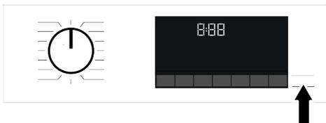
3. La porte de chargement est verrouillée. Une fois la porte de chargement verrouillée, le symbole de verrouillage de la porte apparaît sur l'écran.
