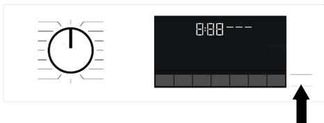
**i** Si la température de l'eau à l'intérieur de la machine est supérieure à 50°C, vous ne pouvez pas désactiver le verrouillage de la porte pour des raisons de sécurité (même si le niveau d'eau est adapté).
