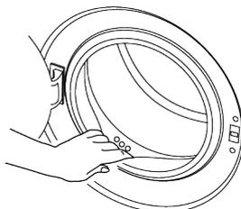
Après chaque lavage, veillez à ce qu'aucun corps étranger ne soit resté dans le produit. Si les orifices qui se trouvent sur le soufflet présenté dans le schéma ci-dessous sont obstrués, débloquez-les à l'aide d'un cure-dent.
