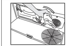
Si vous observez une accumulation de fibres sur le couvercle du ventilateur et la plinthe, enlevez-la à l'aide d'un chiffon.
