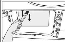
**i** Vous pouvez nettoyer à la main, à condition de porter des gants de protection. N'essayez pas de nettoyer à mains nues. Les ailettes du condenseur peuvent endommager vos mains. Un nettoyage de gauche à droite peut endommager les ailettes du condenseur. Cela peut entraîner des problèmes de séchage.
