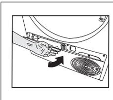
Une fois le processus de nettoyage terminé, placez le couvercle du déflecteur d'air à sa place, déplacez les loquets pour le fermer et fermez la plinthe.
