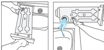
Si des fibres s'accumulent dans l'entonnoir du réservoir d'eau, retirez-les à l'eau courante. Remettez le réservoir d'eau en place.
