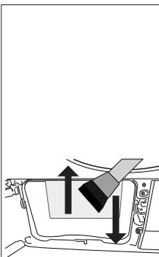
Nettoyez les fibres présentes sur la surface métallique du condenseur à l'aide d'un chiffon humide ou de la brosse rangée sur le déflecteur d'air, en effectuant des mouvements verticaux. Ne nettoyez pas en effectuant des mouvements horizontaux, car cela pourrait endommager les plaques métalliques du condenseur. Vous pouvez utiliser un aspirateur muni d'une brosse pour le nettoyage. Il n'est pas recommandé d'utiliser un aspirateur ne disposant pas de brosse pour nettoyer le condenseur.
