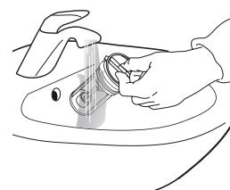
6. Insérez le filtre à eau et remettez en place le bandeau : réinsérez le filtre à eau en le tournant vers la droite. Veillez à le tourner à fond ; la poignée du filtre doit être en position verticale. Afin de tester l'étanchéité du filtre à eau, vous pouvez verser environ 1 litre d'eau dans le distributeur de détergent. Ensuite, réinstallez le bandeau.
