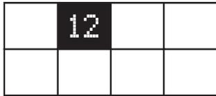
Chaque zone de cuisson présente différents réglages de chaleur, de «1» (puissance minimale) à «18» (puissance maximale). La barre de défilement tactile offre également une fonction de chauffage rapide, indiquée par la lettre «P» sur l'afficheur.
