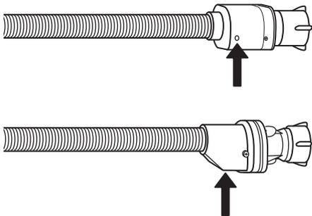
Vérifiez la fenêtre d'inspection de la soupape de sécurité (voir la flèche). Si elle est rouge, cela signifie que la fonction de protection contre les risques d'inondation a été enclenchée ; dans ce cas, le tuyau doit être remplacé par un tuyau neuf. Afin de détacher le tuyau, appuyez sur le bouton de libération (s'il est présent) et dévissez le tuyau.
