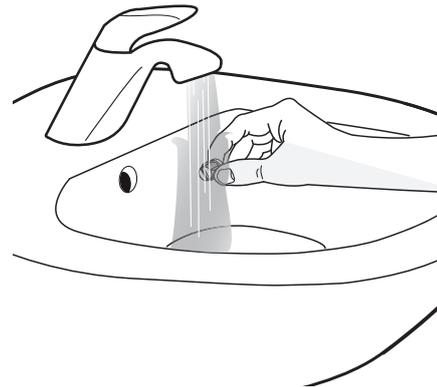
**4.** Remettez le filtre en maille en place. Reconnectez le tuyau d'arrivée d'eau au robinet et au lave-linge. N'utilisez pas d'outils pour raccorder le tuyau d'arrivée d'eau. Ouvrez le robinet d'eau et vérifiez que tous les raccords ont été correctement serrés.
