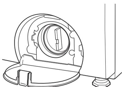
2. Placez un récipient large et plat sous le filtre de la pompe de vidange afin de pouvoir recueillir l'eau. Sortez le tuyau noir, retirez le bouchon et videz le tuyau dans le récipient. Videz le récipient. Si nécessaire, répétez cette procédure jusqu'à ce que toute l'eau ait été évacuée. Vérifiez que le tuyau noir est complètement sec et fermez-le en mettant son bouchon.
