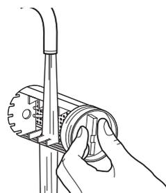
5. Remettez le filtre de la pompe de vidange en place en le tournant dans le sens des aiguilles d'une montre. Veillez à le tourner à fond, avec la poignée du filtre en position verticale.
