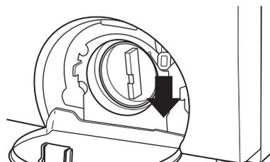
3. Après avoir retiré le linge, si nécessaire, fixez la languette en plastique en remettant en place la vis que vous avez retirée à l'Étape 1 à travers l'orifice de la languette et en la serrant.
