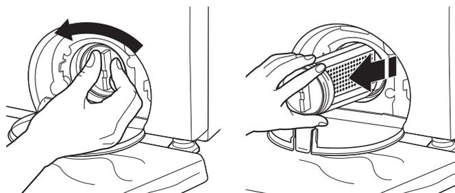
4. Retirez à la main les grosses boules de peluches présentes sur le filtre et jetez-les dans une poubelle adaptée.
