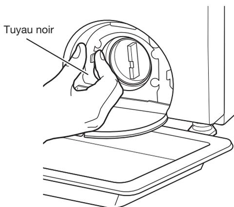
3. Placez un chiffon en coton sous la pompe de vidange pour absorber toute l'eau qui pourrait encore s'y trouver. Ensuite, retirez le filtre de la pompe de vidange en le tournant dans le sens inverse des aiguilles d'une montre.
