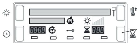
Après avoir sélectionné un programme comportant une option Séchage minuté, appuyez sur le bouton de durée de séchage
