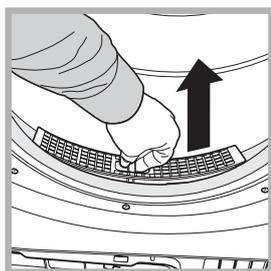
Par conséquent, une fois le séchage terminé, nettoyez le filtre en le rinçant sous l'eau courante ou avec votre aspirateur. Si le filtre devient bloqué, le flux d'air à l'intérieur du sèche-linge est sérieusement compromis : les temps de séchage sont allongés et vous consommez davantage d'énergie. Cela peut aussi endommager votre sèche-linge. Le filtre se trouve devant
