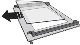
3. Remplacez la paroi du milieu (marquée d'un « 1R ») avant de replacer la paroi intérieure : Pour placer correctement les parois de verre, assurez-vous que la marque « R » se trouve dans le coin gauche. En premier, insérez la longue partie de la vitre marquée d'un « R » dans les appuis des guides, abaissez-la ensuite en place. Répétez cette procédure pour les deux parois de verre.
