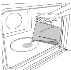
Pour démarrer la fonction Vapeur, versez 200 ml d'eau potable dans le fond du four. Sélectionnez la fonction en tournant le bouton de sélection dans le sens des aiguilles d'une montre sur l'icône correspondante, et le bouton de thermostat dans n'importe quelle position entre 160 et 180°C (comme suggéré par l'icône). La
