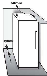
Vzdialenosť medzi zadnou stenou spotrebiča a stenou za ním by mala byť aspoň 50 mm.
