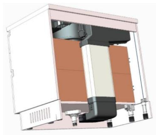
Schéma d'encastrement (profondeur plan de travail 60cm)
