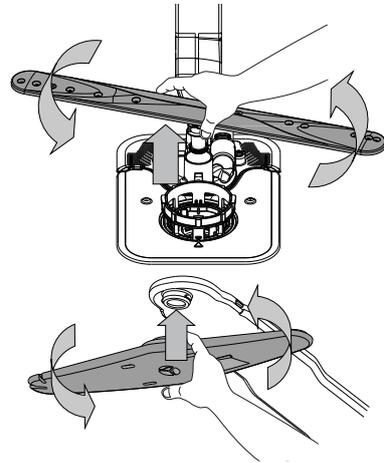
Le bras d'aspersion inférieur se démonte en le tirant vers le haut, tout en le tournant dans le sens inverse des aiguilles d'une montre. Pour remonter le bras d'aspersion inférieur, il faut le pousser vers le bas tout en le tournant dans le sens des aiguilles d'une montre.
