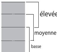
La zone flexible est divisée en trois zones de cuisson (voir la figure) activées à une puissance préétablie (élevée, moyenne ou basse) en fonction de la position de la casserole/poêle: déplacer la casserole/poêle sur la surface pour poursuivre la cuisson à des températures différentes sans avoir à utiliser les commandes.
