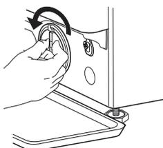
4. Retirez le filtre : placez un chiffon en coton sous le filtre à eau, afin d'absorber une petite quantité d'eau résiduelle. Puis retirez le filtre à eau en le faisant tourner vers la gauche.
