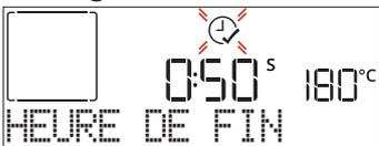
Appuyez sur + ou - pour régler l'heure à laquelle vous souhaitez que la cuisson se termine, puis appuyez sur ✓ pour confirmer et activer la fonction. Placez les aliments dans le four et fermez la porte : La fonction démarre automatique après une période de temps déterminée pour que la cuisson se termine au moment désiré.
