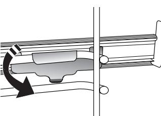
För att säkra sidostegen, tryck den nedre delen av klämmen stadigt mot sidostegen. Säkerställ att teleskopskkenorna kan röra sig fritt. Upprepa dessa steg på den andra ugnsstegen på samma nivå.
