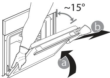
**3.** Įstatydami dureles pastumkite jas link orkaitės, suligiuokite vyrių kabliukus tvirtinimo vietose ir užfiksuodami viršutinę dalį.
