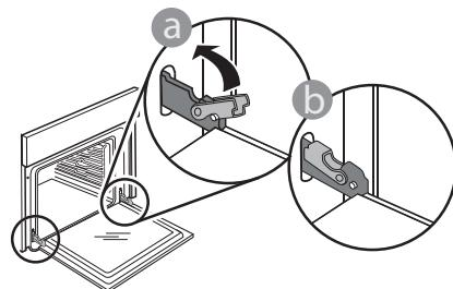
Tryck en aning på dem för att kontrollera att spärrarna är i korrekt läge.
