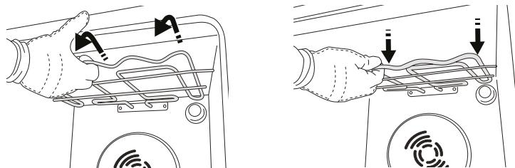
**3.** För att sätta tillbaka elementet, lyft det, dra det en aning mot dig, och se till att det vilar i sina sidostöd.
