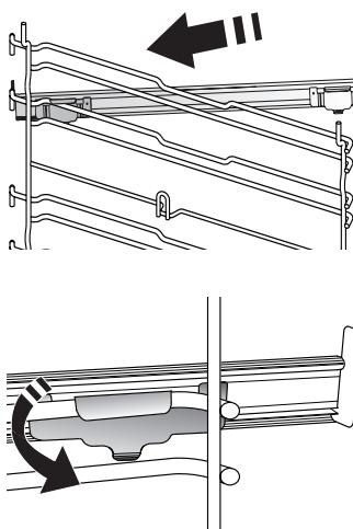
Da vodila zavarujete, spodnji del sponke čvrsto pritisnite na vodila za pekače. Prepričajte se, da je mogoče drsna vodila nemoteno premakniti. Postopek ponovite na drugem vodilu za pekače, ki je na enaki višini.
