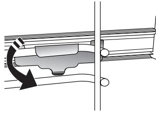
Retire as guias de nível do forno e remova o plástico de proteção das corrediças.
