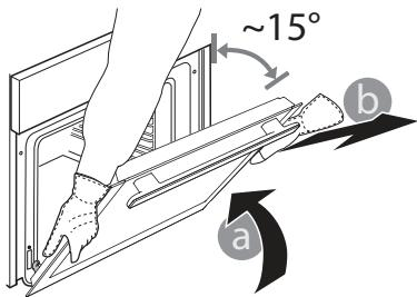
**3.** Dvířka opět nasadíte tak, že je přiložíte k troubě, nasmerujete háčky pantů oproti jejich usazení a do příslušného usazení zajistíte i horní část.
