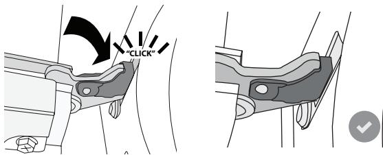
**5.** Probeer de deur te sluiten en controleer of het in lijn met het bedieningspaneel is. Als dit niet het geval is herhaalt u de bovenstaande stappen: als het niet goed werkt kan de deur beschadigd raken.
