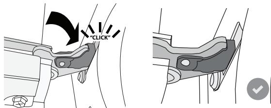
**5.** Zkuste dvířka zavřít a zkontrolujte, zda jsou v jedné rovině s ovládacím panelem. Pokud tomu tak není, výše uvedený postup opakujte: Pokud dvířka správně nefungují, mohou se poškodit.
