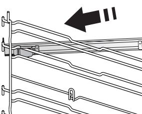
Uklonite vodilice rešetki iz pećnice i uklonite zaštitnu plastiku s kliznih vodilica.
