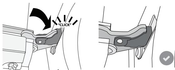
**5.** Poskusite zapreti vrata in preverite, da so poravnana z upravljalno ploščo. Če vrata niso poravnana, ponovite zgoraj opisane korake: če se vrata ne odpirajo in zapirajo pravilno, se lahko poškodujejo.
