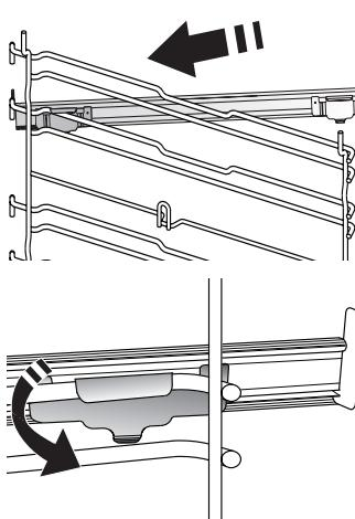
Vyberte vodiace lišty z rúry a z posuvných bežcov odstráňte ochranné plasty. Pripojte vrchnú svorku bežca na vodiaciu lištu a nasuňte, pokiaľ to ide. Druhú svorku spustite na miesto.
