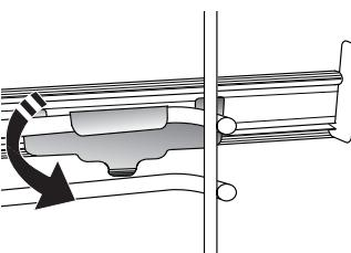
Aby byla vodicí mřížka dobře zajištěna, zatlačte pevně spodní část spony oproti vodicí mřížce. Ujistěte se, že drážkami lze volně pohybovat. Postupujte stejně i na druhé straně vodicí mřížky v rámci stejné výškové úrovně.
