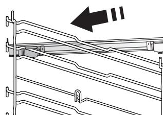
Die Seitengitter aus dem Ofen nehmen und den Kunststoffschutz von den Backauszügen entfernen. Den oberen Clip des Backauszugs am Seitengitter befestigen und ihn so weit wie möglich entlang gleiten lassen. Den anderen Clip in seine Position absenken.
