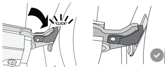
**5.** Yritä sulkea luukku ja varmista, että se on tasassa käytöpaneelin kanssa. Jos näin ei ole, toista yllä olevat vaiheet: Jos luukku ei toimi oikein, se saattaa vahingoittua.
