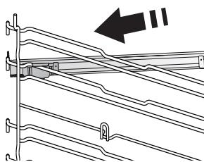
Extraiga las guías para los estantes del horno y quite el plástico de protección de las guías deslizantes.
