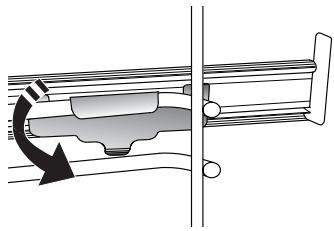
Pour fixer le guide, pressez la partie inférieure de l'agrafe fermement sur le support de grille. Assurez-vous que les rails peuvent se déplacer librement. Répétez ces étapes pour l'autre support de grille du même niveau.
