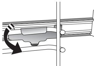
Išimkite lentynų laikiklius iš orkaitės ir nuimkite apsaugines plastikines dalis nuo slankiojančių grotelių. Viršutinių grotelių fiksatorių pritvirtinkite prie skersinių grotelių ir nustumkite jų į galą. Į tą padėtį nuleiskite ir kitą fiksatorių.
