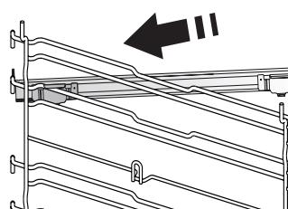
Die Seitengitter aus dem Ofen nehmen und den Kunststoffschutz von den Backauszügen entfernen. Den oberen Clip des Backauszugs am Seitengitter befestigen und ihn so weit wie möglich entlang gleiten lassen. Den anderen Clip in seine Position absenken.
