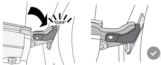
**5.** Zkuste dvírka zavřít a zkontrolujte, zda jsou v jedné rovině s ovládacím panelem. Pokud tomu tak není, výše uvedený postup opakujte: Pokud dvírka správně nefungují, mohou se poškodit.
