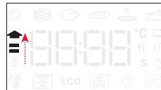
Po završetku te faze oglasit će se zvučni signal i na zaslonu će se prikazati da je pećnica dosegnula postavljenu temperaturu.
