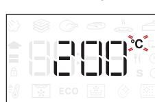
Ked' na displeji bliká ikonka °C, otáčaním gombíka zmeňte hodnotu, potvrďte stlačením a pokračujte zmenou ďalších nastavení (ak je to možné).
