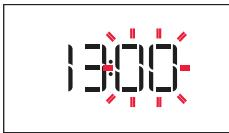
Števki za minute začneta utripati. Z obračanjem gumba nastavite minute in pritisnite za potrditev. Opomba: za poznejšo spremembo časa vsaj eno sekundo držite , ko je pečica izkopljena, in ponovite zgoraj opisane korake.
