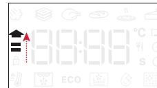
A fázis végeztével hangjelzés hallható, és a kijelzőn üzenet jelzi, hogy a sütő elérte a megadott hőmérsékletet.
