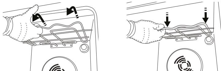
**3.** Za ponovo namještanje grijača, podignite lagano ga povlačeći prema sebi i provjerite je li sjeo na bočne nosače.
