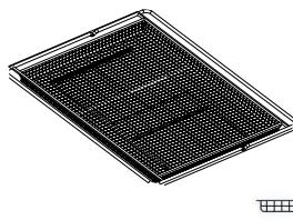
Para utilizar cuando se cocinan alimentos con la función Freidora de aire, con una bandeja de horno colocada a un nivel inferior para recoger posibles migas y goteos. Se puede lavar en el lavavajillas.
