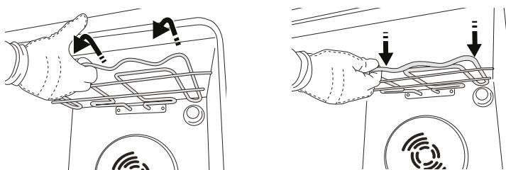
**3.** Zpět ho vrátíte tak, že ho zvednete nahoru a přitom mírně přitáhněte směrem k sobě. Zkontrolujte, zda leží na bočních držácích.
