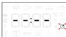
Коли на дисплей блимає значок , за допомогою кнопки регулювання встановіть бажаний час готовування, а потім натисніть кнопку для підтвердження.
