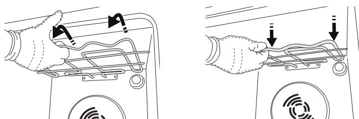
**3.** Para volver a situar la resistencia en su posición, elevarla, tirar de ella ligeramente hacia fuera y comprobar que queda apoyada en las sujeciones laterales.
