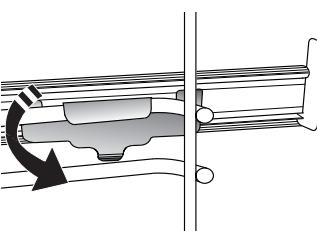
Uklonite vodilice rešetki iz pećnice i uklonite zaštitnu plastiku s kliznih vodilica. Pričvrstite gornju kopču vodilice na vodilicu rešetke i do kraja je klizno pomaknite. Donju kopču spustite u položaj.
