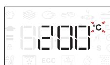
Când pictograma °C clipește pe afișaj, rotiți butonul pentru modificarea valorii, apoi apăsați pentru confirmare și continuați să modificați următoarele setări (dacă este posibil).
