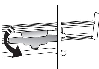
Pentru a fixa ghidajul, apăsați ferm portiunea inferioară a clemei spre ghidajul pentru grătar. Asigurați-vă că şinele se pot deplasa liber. Repetați acești pași și pentru celălalt ghidaj pentru grătar de la același nivel.
