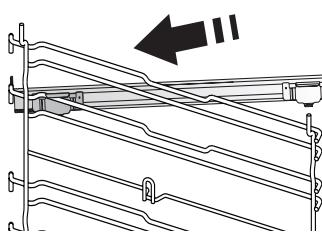
Vyberte vodiacie lišty z rúry a z posuvných bežcov odstráňte ochranné plasty. Pripevnite vrchnú svorku bežca na vodiacu lištu a nasuňte, pokiaľ to ide. Druhú svorku spustite na miesto.
