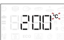
Kad ikona °C treperi na zaslonu, okrenite gumb za promjenu vrijednosti pa pritisnite za potvrdu te nastavite s promjenom sljedećih postavki (ako je moguće). Istovremeno možete postaviti i razinu roštilja (3 = visoka, 2 = srednja, 1 = niska).
