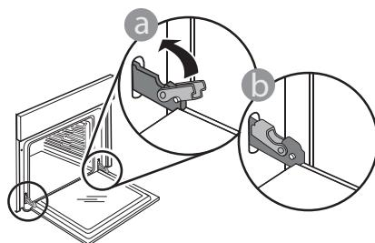
Z nežnim pritiskom preverite, ali sta zaporna vzdova v pravilnem položaju.
