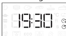
Let op: Wanneer er een uitgestelde bereidingsstarttijd wordt geprogrammeerd wordt de voorverwarmingsfase van de oven uitgeschakeld: De oven zal de gewenste temperatuur geleidelijk bereiken, wat betekent dat de bereidingstijden iets langer zijn dan inde bereidingsstabbel staat vermeld.
