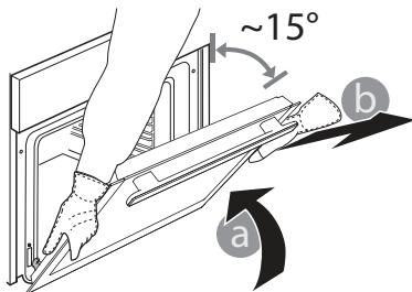
**3.** Dvírka opět nasadíte tak, že je přiložíte k troubě, nasměrujete háčky pantů oproti jejich usazení a do příslušného usazení zajistíte i horní část.
