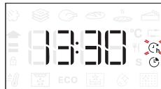
V případě potřeby otáčejte knoflíkem a nastavte požadovaný čas ukončení přípravy. Poté, pro potvrzení volby a spuštění funkce, stiskněte . Vložte pokrm do trouby a zavřete dvířka: Funkce se spustí automaticky po určité době, která byla vypočtena tak, aby příprava pokrmu byla dokončena ve vám nastaveném čase.
