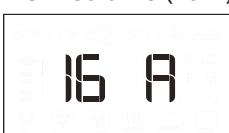
Den Auswahlknopf zur Auswahl des Nennstroms drehen, anschließend zur Bestätigung drücken.
