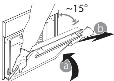
**3.** Monteer de deur terug door deze naar de oven te duwen, de haken van de scharnieren uit te lijnen met de zitting en het bovenste deel op de zitting vast te zetten..
