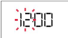
Op het display knipperen de twee cijfers die de uren aangeven: Draai aan de knop om de uren in te stellen en druk op om te bevestigen.
