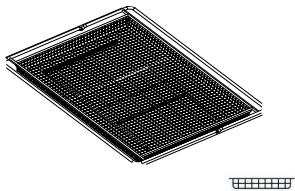
Να χρησιμοποιείται όταν μαγειρεύετε φαγητά με τη λειτουργία τηγανίσματος με αέρα, με ένα ταψί τοποθετημένο σε χαμηλότερο επίπεδο για να συλλέγει πιθανά ψίχουλα και σταγόνες. Μπορεί να πλυθεί στο πλυντήριο πιάτων.
