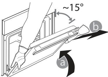
**3.** Ukse tagasi paigaldamiseks asetage see vastu ahju, joondage hingedede haagid pesadega ja kinnitage ülemine osa oma pessa.
