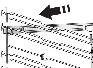
Išimkite lentynų laikiklius iš orkaitės ir nuimkite apsaugines plastikines dalis nuo slankiojančių grotelių. Viršutinį grotelių fiksatorių pritvirtinkite prie skersinių grotelių ir nustumkite jį į galą. Į tą padėtį nuleiskite ir kitą fiksatorių.
