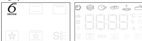
Gire el selector rotativo para seleccionar una de las subfunciones disponibles en la parte derecha de la pantalla y después pulse para confirmar.
