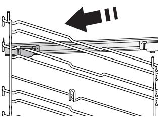
Extraiga las guías para los estantes del horno y quite el plástico de protección de las guías deslizantes.
