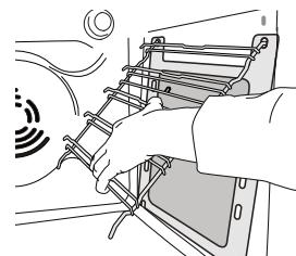
Za najbolje korišćenje funkcije samočišćenja katalitičkih ploča, preporučujemo grejanje rerne na 200 °C oko sat vremena pomoću funkcije „Konvekciono Pečenje“. Tokom ovog procesa, pećnica mora biti prazna. Zatim ostavite uređaj da se ohladi pre nego što neabrazivnim sunđerom skinete sve ostatke hrane.
