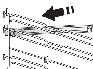
Demontați ghidajele pentru grătar din cuptor și îndepărtați folia protectoare din plastic de pe şinele culisante.
