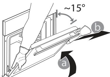
**3.** Remontați ușa deplasând-o spre cuptor, aliniind cuplajele bałamalelor cu locașurile și fixând partea superioară în locaș.
