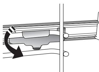
Um die Führungen zu sichern, den unteren Teil des Clips fest gegen das Seitengitter drücken. Sicherstellen, dass sich die Backauszüge frei bewegen können. Diese Schritte am anderen Seitengitter auf der gleichen Einschubebene wiederholen.
