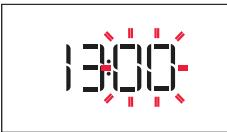
A kijelzőn villogni kezd a percet jelző két számjegy: Fordítsa el a gombot a perc beállításához, majd nyomja meg a gombot a megerősítéshez.
