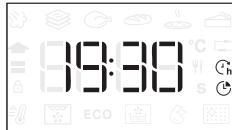
Зверніть увагу: У разі програмування часу відкладеного запуску готовування фазу попереднього прогрівання буде скасовано: Розігрівання духової шафи до встановленої температури буде поступовим, а це означає, що час готовування буде трохи більшим за час, наведений у таблиці приготування.
