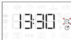
За необхідності поверніть ручку регулювання, щоб встановити бажаний час завершення готовування, потім натисніть для підтвердження і запуску функції.
