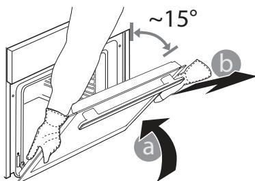
**3.** Réinstallez la porte en la plaçant devant le four pour aligner les crochets des charnières avec leurs appuis, et insérez la partie supérieure sur son appui.
