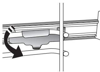
Щоб зафіксувати напрямну, міцно притисніть нижню частину затискача до напрямної для полички. Переконайтесь, що рух телескопічних напрямних нічого не заважає. Повторіть ці дії з іншою напрямною для решітки на тому ж рівні.
