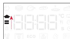
Після завершення фази пролунає звуковий сигнал, а на дисплей з'явиться сповіщення про те, що духовна шафа досягла заданої температури.
