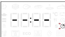
Wenn das Symbol auf dem Display blinkt, den Einstellknopf zum Einstellen der gewünschten Garzeit verwenden und anschließend zur Bestätigung drücken. Die Garzeit muss nicht eingestellt werden, wenn der Garvorgang manuell gehandhabt wird: Drücken Sie zum Bestätigen und Starten der Funktion. In diesem Fall kann kein Garzeitende durch Programmierung einer Startverzögerung eingestellt werden.
