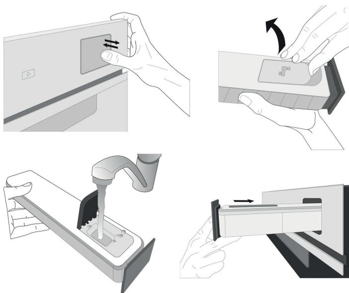
Après le premier remplissage, en cas de cycles de cuisson plus longs, une fois que l'eau se sera épuisée, il pourrait être nécessaire d'en ajouter à nouveau, afin de terminer le cycle : le four invitera à le faire en cas de besoin.
