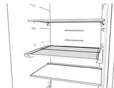
2. Demi-profondeur, pour utiliser la partie arrière et en même temps, créer de l'espace pour des articles plus grands (comme les bouteilles et les carafes) sur la clayette inférieure. Pour ajuster la clayette à demi-profondeur, soulevez légèrement la partie avant puis tirez-la vers l'intérieur.
