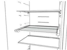
2. Demi-profondeur, pour utiliser la partie arrière et en même temps, créer de l'espace pour des articles plus grands (comme les bouteilles et les carafes) sur la clayette inférieure. Pour ajuster la clayette à demi-profondeur, soulevez légèrement la partie avant puis tirez-la vers l'intérieur.
