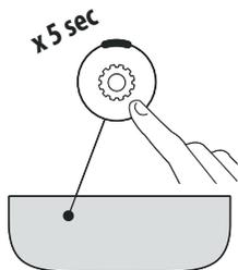
Maintenir enfoncée la touche pendant quelques secondes : les touches relatives aux paramètres s'allument. Appuyer sur la touche relative au paramètre à régler.
