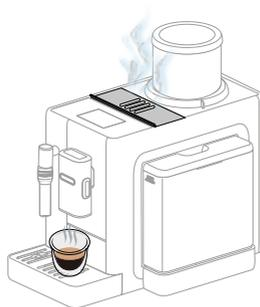
*Il s'agit de la vapeur dégagée par la dose de café utilisée et éliminée automatiquement dans le bac à marc de la machine. Cela fait partie du fonctionnement normal et correct de la machine.*
