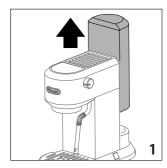
Ouvrir le couvercle du réservoir d'eau (A1) et remplir le réservoir d'eau (A2) avec de l'eau potable fraîche, en veillant à ne pas dépasser le niveau MAX (fig. 2).
