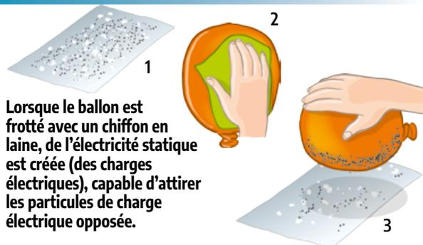
Lorsque le ballon est frotté avec un chiffon en laine, de l'électricité statique est créée (des charges électriques), capable d'attirer les particules de charge électrique opposée.
