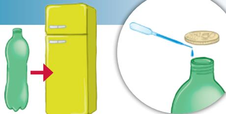
En passant du congélateur à l'extérieur, l'air à l'intérieur de la bouteille se réchauffe et se dilate, soulevant ainsi la pièce.
