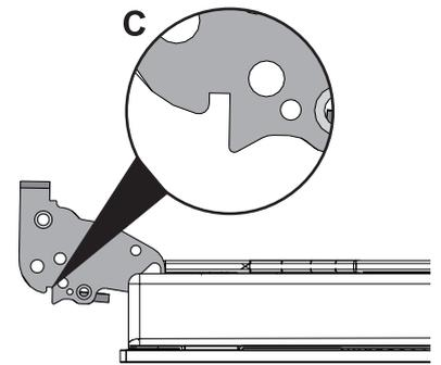
Pour remonter la porte, introduisez les charnières dans les fentes prévues à cet effet sur le four en s'assurant que les rainures C sont complètement posées contre la base des fentes. Abaissez la porte puis, après l'avoir positionnée, sortez les pivots des trous des charnières.
