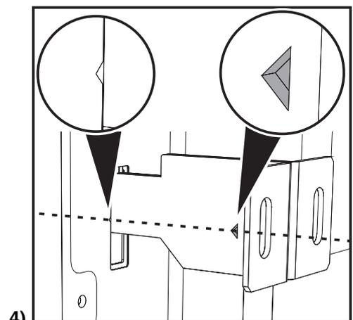
4) Avant de serrer complètement les pattes au mur, vérifiez que l'index présent sur les pattes se trouve à la même hauteur que l'index situé à l'arrière de l'appareil. Positionnez l'appareil en veillant à ce que les pattes s'introduisent correctement.
