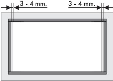
2. Appuyez légèrement dessus pour qu'il adhère bien à la surface du périmètre extérieur de l'ouverture découpée dans le plan de travail ; les côtés avant et arrière du joint doivent se trouver au ras de l'ouverture.
