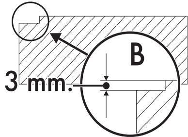
Ce modèle à encastrement prévoit un fraisage du plan de travail de 3 mm d'épaisseur (détail « B » de la figure ci-dessus).
