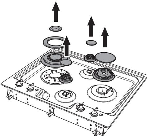
3. À l'aide d'une clé à douille de 7 mm, dévissez les injecteurs des brûleurs et procédez au remplacement de ces derniers en fonction du gaz à utiliser (voir les « Tableaux des caractéristiques des brûleurs et injecteurs »).
