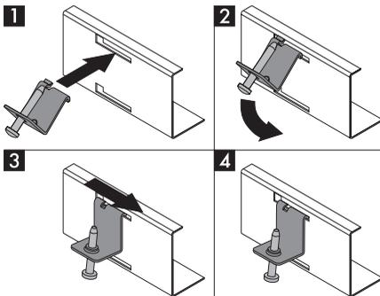
3. Posez la table sur le joint isolant et fixez-la à la structure de support avec les vis et les étriers de fixation fournis (A) jusqu'à l'obtention d'une planéité parfaite.
