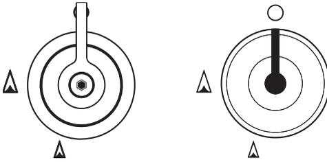
Utiles pour allumer et régler les brûleurs du plan. Enfoncez et tournez les manettes dans le sens inverse des aiguilles d'une montre sur la valeur ▲ pour allumer les brûleurs correspondants. Tournez les manettes sur la zone comprise entre le maximum ▲ et le minimum ▲ pour régler l'intensité de la flamme. Ramenez les manettes sur la position ○ pour éteindre les brûleurs.
