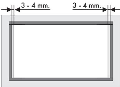
2. Appuyez légèrement dessus pour qu'il adhère bien à la surface du périmètre extérieur de l'ouverture découpée dans le plan de travail ; les côtés avant et arrière du joint doivent se trouver au ras de l'ouverture.
