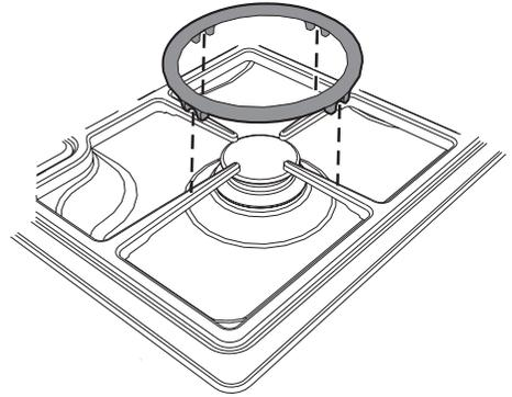
La réduction doit être placée sur la grille de la table de cuisson, comme montré sur la figure ci-dessus.
