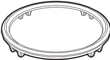
Pour éviter que le plan de travail ne se détériore, une grille rehaussée est disponible qui doit être installée sous les casseroles dont le diamètre est supérieur à ceux indiqués dans le tableau « Diamètres des récipients » du paragraphe 3.3 « Utilisation de la table de cuisson ».
