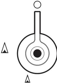
Utiles pour allumer et régler les brûleurs du plan. Enfoncez et tournez les manettes dans le sens inverse des aiguilles d'une montre sur la valeur ▲ pour allumer les brûleurs correspondants. Tournez les manettes sur la zone comprise entre le maximum ▼ et le minimum ▲ pour régler l'intensité de la flamme. Ramenez les manettes sur la position ○ pour éteindre les brûleurs.
