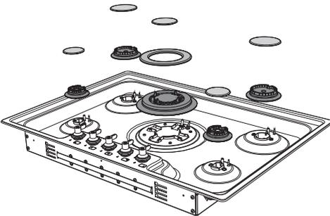
3. À l'aide d'une clé à douille de 7 mm, dévissez les injecteurs des brûleurs et procédez au remplacement de ces derniers en fonction du gaz à utiliser (voir les « Tableaux des caractéristiques des brûleurs et injecteurs »).
