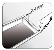
Ces opérations terminées, posez le plan sur le joint isolant et avec les vis et les pattes de fixation, fixez le plan à la structure de support de manière à ce qu'il soit parfaitement horizontal.
