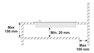
IMPORTANT: si l'appareil est monté sur un meuble, prévoir l'installation d'une tablette de séparation (voir figure).
