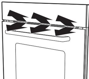
La turbine refroidit l'appareil et se met en marche pendant la cuisson.
