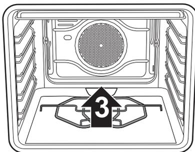
Remplacez la sole d'appui de la pierre à pizza, en la poussant contre le panneau de fond du four et abaissez-la de manière à ce que la plaquette de la résistance s'encastre dans la base.
