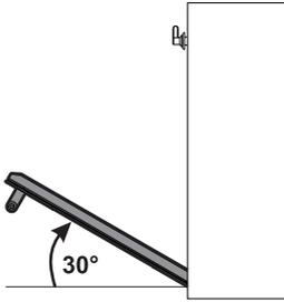
3. Pour remonter la porte, introduisez les charnières dans les fentes prévues à cet effet sur le four en vous assurant que les rainures **A** sont complètement posées contre les fentes. Abaissez la porte puis, après l'avoir positionnée, sortez les pivots des trous des charnières.
