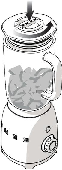
4. Branchez le cordon d'alimentation du mixeur sur la prise de courant. La DEL rouge s'allumera pour indiquer la présence de tension. Sélectionnez la vitesse souhaitée ou un programme présélectionné par l'intermédiaire de la manette de commande ou appuyez sur le bouton **PULSE** pour le démarrer manuellement.
