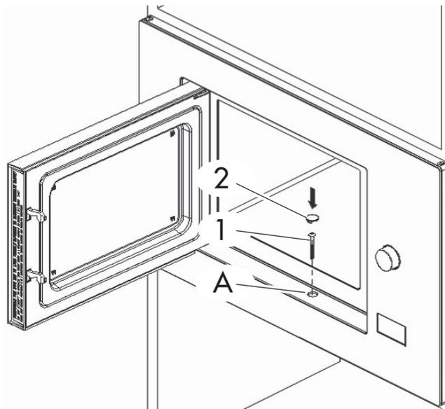
2. La bride inférieure est juste installée contre la coque arrière du four.
