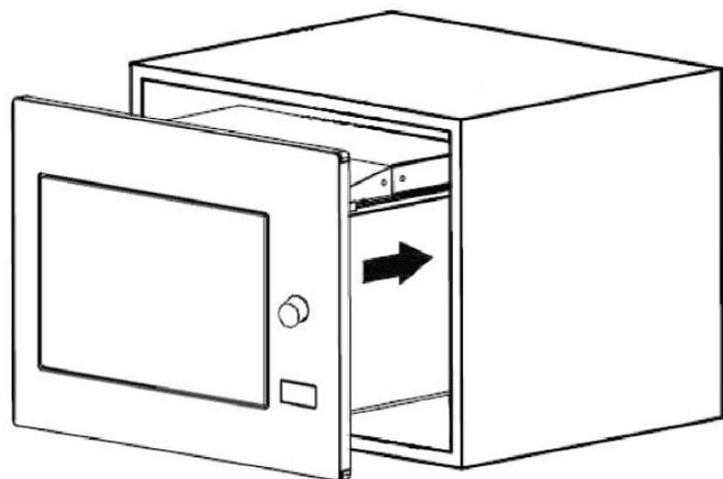
4. Fixez le four au meuble avec la vis (1) au trou d'installation (A) du kit de garniture.
