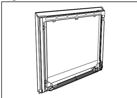
4. Après le nettoyage, repositionnez la vitre interne dans les pattes. Veillez à centrer et à encaster les 4 pivots dans leurs logements sur la porte, aidez-vous des joints placés à
