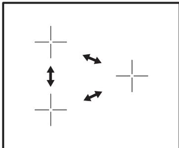
Lorsque vous réglez la fonction Limitation de puissance sur **plus de 6,0 kW**, la puissance de la table de cuisson est répartie entre deux zones de cuisson fonctionnant en paire.
