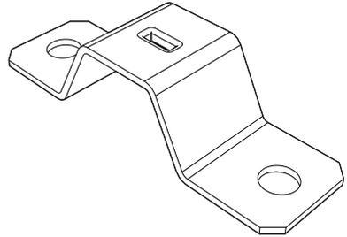
En cas de raccordement biphasé ou triphasé, pour une fixation correcte du câble, il faut remplacer le cavalier installé par le cavalier fourni.
