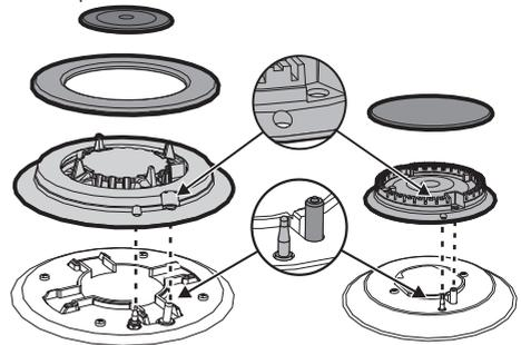
2. Remplacez les injecteurs en utilisant une clé à tube de 7 mm en fonction du gaz à utiliser (voir « Tableaux des caractéristiques des brûleurs et injecteurs »).
