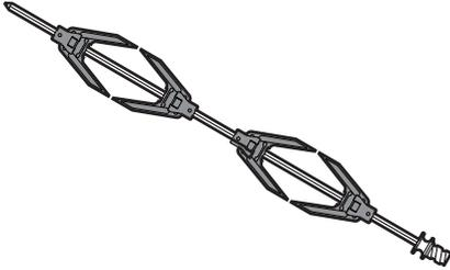
4. Après avoir préparé la broche, positionnez-la sur les supports correspondants. Introduisez à fond la pointe de la broche dans le logement du mécanisme situé sur le support gauche.
