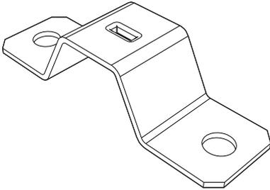
En cas de branchement biphasé et ou triphasé, pour une fixation correcte des câbles, vous devez remplacer le cavalier préinstallé par le cavalier fourni à cet effet.
