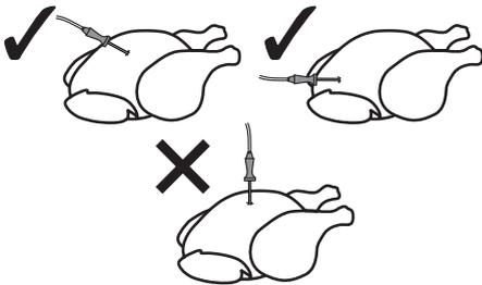
**i** Pour une mesure précise de la température au cœur de l'aliment, la pointe de la sonde ne doit pas entrer en contact avec les os ou les parties grasses.
