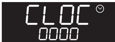
3. Tournez la **manette Sélection**
