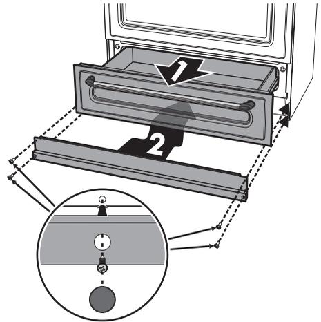
2. Positionnez le socle dans la partie inférieure avant de l'appareil.
