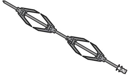
4. Après avoir préparé la broche, positionnez-la sur les supports correspondants. Introduisez à fond la pointe de la broche dans le logement du mécanisme situé sur le support gauche.
