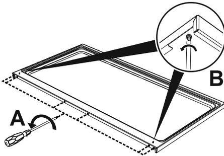
2. Positionnez la réhausse au-dessus du plan. Faites correspondre les 6 rainures inférieures du dossieret et les 6 vis situées à l'arrière du plan desserrées précédemment.
