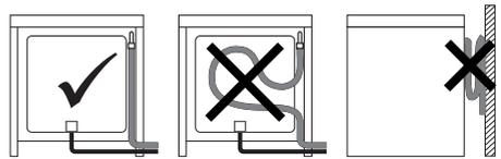
Effectuez le raccordement au réseau de distribution du gaz à l'aide d'un tuyau en caoutchouc conforme aux caractéristiques visées par la norme en vigueur (vérifiez que le sigle de la norme est bien imprimé sur le tuyau).
