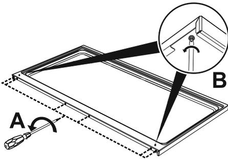
2. Positionnez la réhausse au-dessus du plan. Faites correspondre les 6 rainures inférieures de la réhausse et les 6 vis situées à l'arrière du plan desserrées précédemment.
