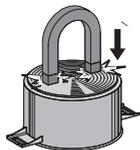
**Remarque :** utilisez exclusivement des récipients avec un fond parfaitement plat et adapté aux plaques de cuisson à induction. Utiliser des récipients avec un fond irrégulier peut menacer l'efficacité du système de chauffage et empêcher la détection du récipient sur la zone de cuisson.
