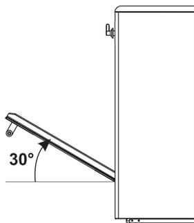
3. Pour remonter la porte, insérez les charnières dans les fentes prévues situées sur l'appareil en vous assurant que les rainures **A** sont complètement posées contre les fentes. Abaissez la porte puis, après l'avoir positionnée, sortez les pivots des trous des charnières.
