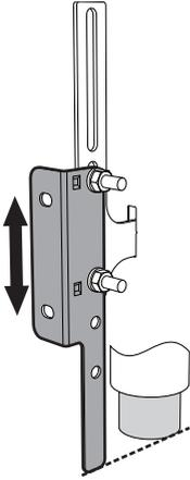
7. Déplacez la bride sur le mur et marquez la position des trous à réaliser dans le mur.
