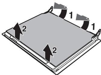
3. Démontez la vitre intermédiaire en la soulevant vers le haut, en suivant la procédure décrite pour la vitre interne mais en veillant à pousser la partie avant de la vitre (2) vers l'intérieur de l'appareil.
