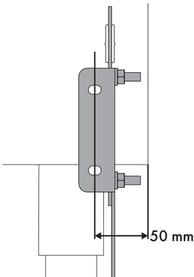
8. Après avoir réalisé les trous dans le mur, utilisez des chevilles avec des vis pour fixer la bride sur le mur.
