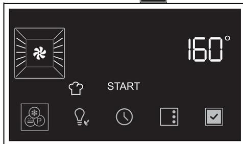
6. Tournez la manette de la température pour sélectionner la température souhaitée (de 50 °C à 250°C).
