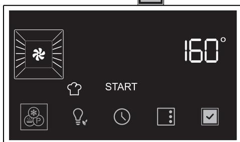
3. Tournez la manette de la température pour sélectionner la température souhaitée (de 50 °C à 250°C).
